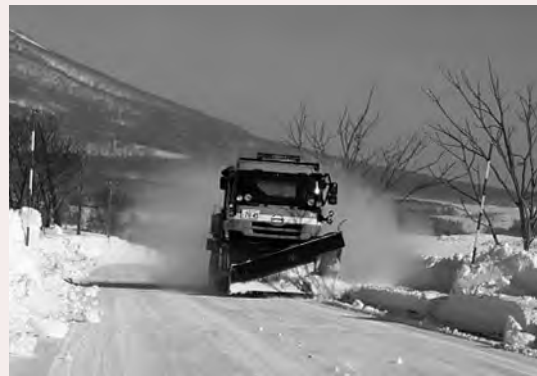
▲除雪車による作業の様子
